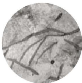
Fotomicrografic arătând formațiunile de grafit la fonta gri
